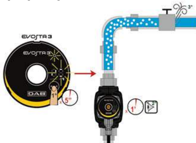
Fig. 8: Automatisk udluftning af pumpe
