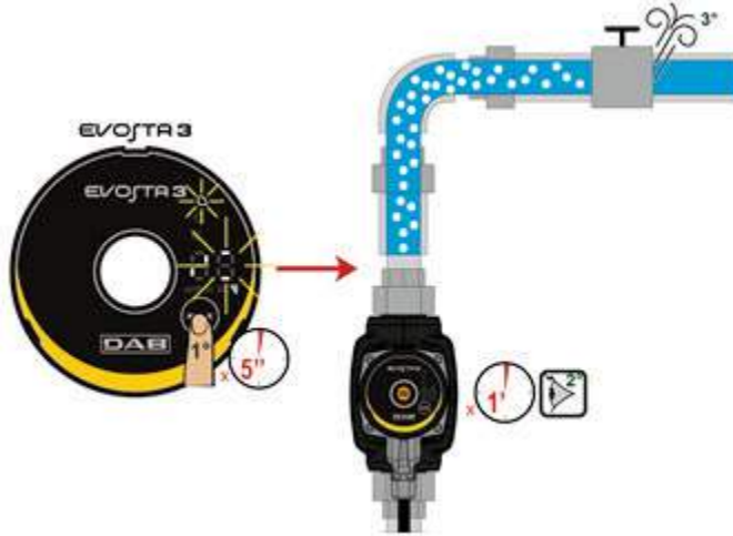
Resim 8: Pompanın havasının otomatik boşaltılması
