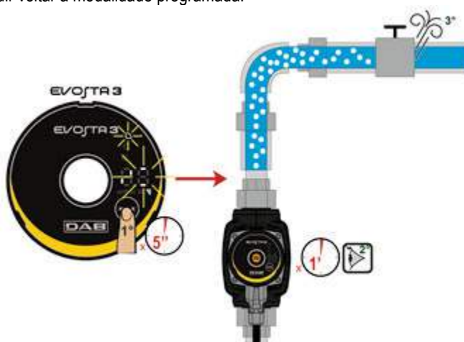
Figura 8: Drenagem automática da bomba
