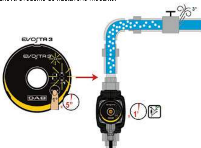
Obrázok 8: Automatické odvzdušnenie čerpadla
