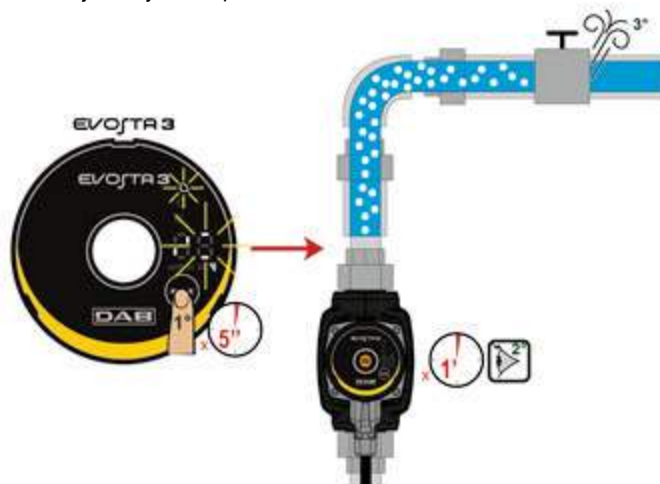
Kuva 8: Pumpun automaattinen ilmaus
