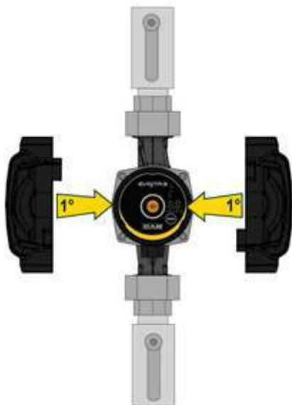
Obrázek 6: Izolace tělesa čerpadla
