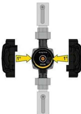
Рисунок 6: Изоляция корпуса насоса
