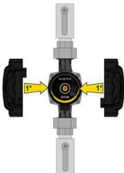
6 pav.: Siurblio korpuso izoliavimas
