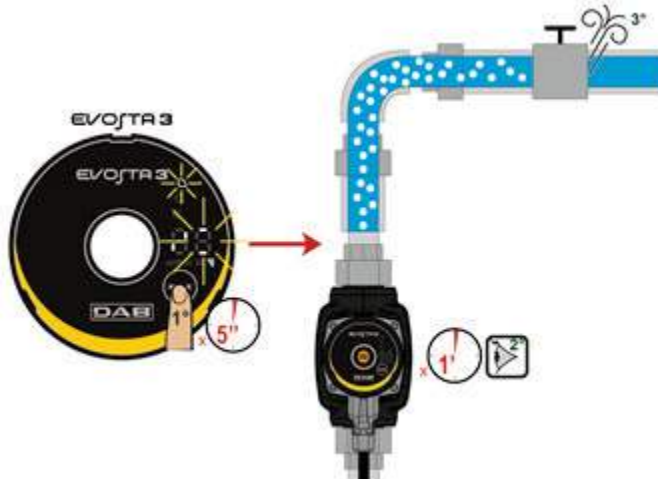
Малюнок 8: Автоматичний випуск газів з насоса
