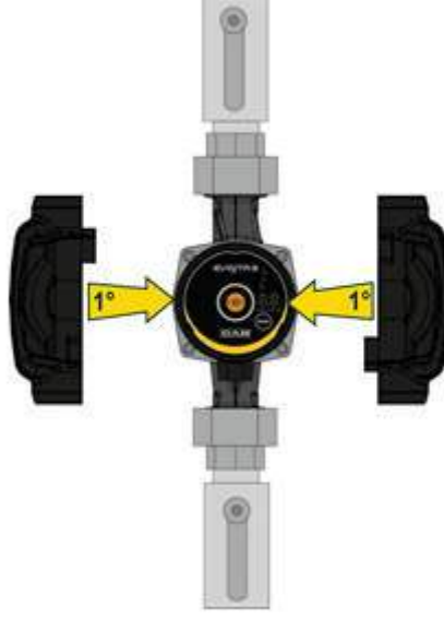
Resim 6: Pompa gövdesinin yalıtımı
