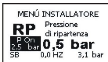
Рисунок 19: Настройка давления нового включения
