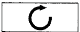
Electrobomba con sentido de rotación horario visto desde la boca de impulsión
