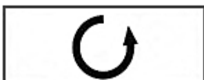
Electropompe cu sens de rotație invers acelor de ceasornic văzute de la gura
