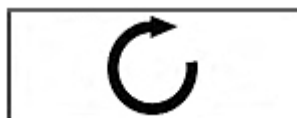
Electrobombas con sentido de rotación horario visto desde la boca de impulsión
