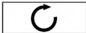
Electropompe cu sens de rotație orar văzute de la gura de tur
