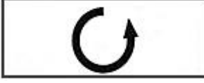
مضخات كهربائية مع اتجاه دوران باتجاه عقارب عقارب الساعة بالروية من فوهة الدفع
