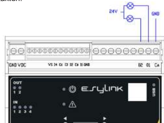
Abbildung 3: Beispiel für den Anschluss der Ausgänge
