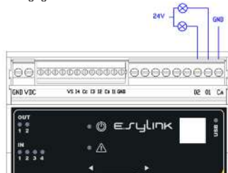
Afbeelding 3: Aansluitvoorbeeld van de uitgangen
