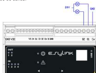
Figura 3: Ejemplo de conexión salidas
