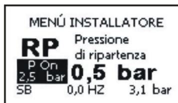
Abbildung 18: Einstellung des Neustartdrucks
