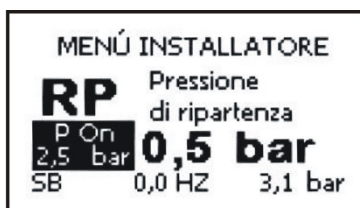
Figure 18: Configuration de la pression de redémarrage
