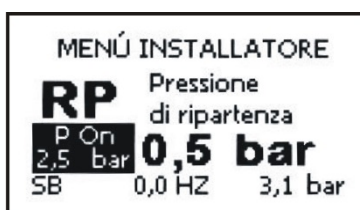
Рисунок 11: Встановлення тиску перезапуску
