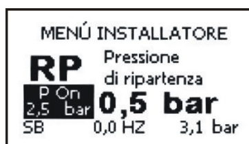
Rysunek 17: Ustawianie ciśnienia ponownego uruchomienia
