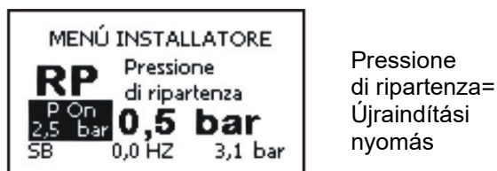
18.ábra: Az újraindítási nyomás beállítása
