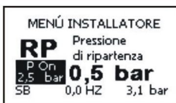
Afbeelding 18: instelling van de druk voor herstart
