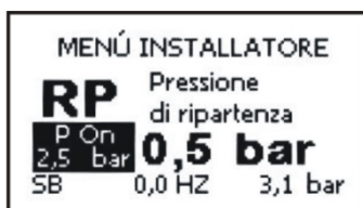
Obrázek 18: Nastavení tlaku pro restart čerpadla
