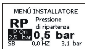
Figura 18: Configuración de la presión por re arranque
