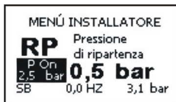
Σχήμα 17: Ρύθμιση της πίεσης επανεκκίνησης
