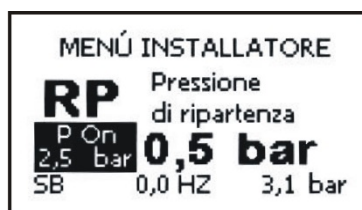
Рисунок 18: Настройка давления нового включения
