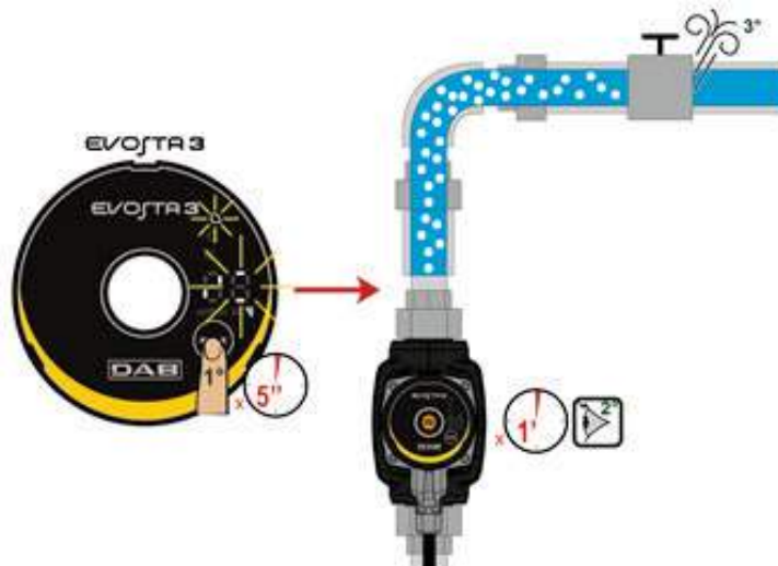
Fig 8: Automatisk avluftning av pumpen
