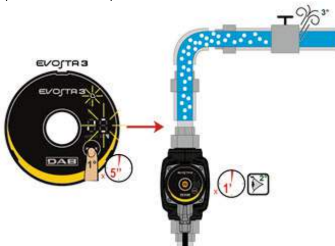
Figura 8: Sfiato automatico della pompa
