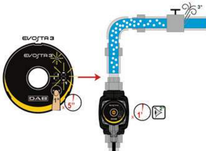
Afbeelding 9: Automatische ontluchting van de pomp
