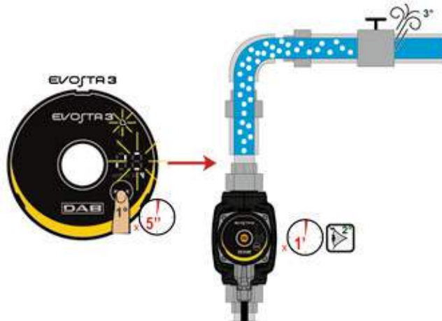
Image 8: Purge automatique de la pompe
