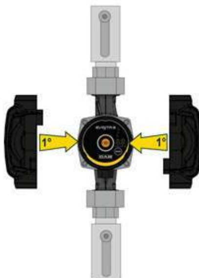
Image 6: Isolation du corps de pompe
