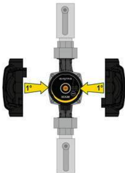
Rysunek 6: Izolacja korpusu pompy
