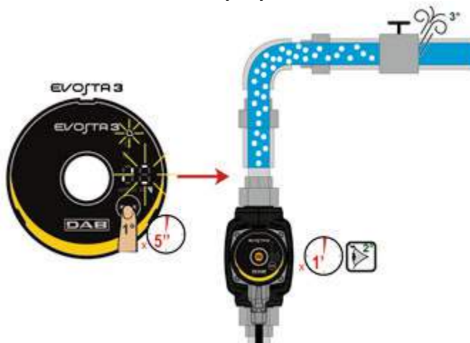
Joonis 8: Pumba automaatne õhutustamine
