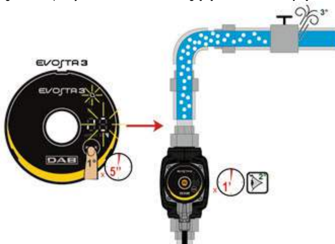
8 pav.: Automatinis oro išleidimas iš siurblio
