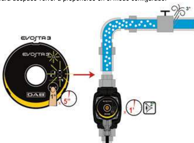
Figura 9: Purga automática de la bomba
