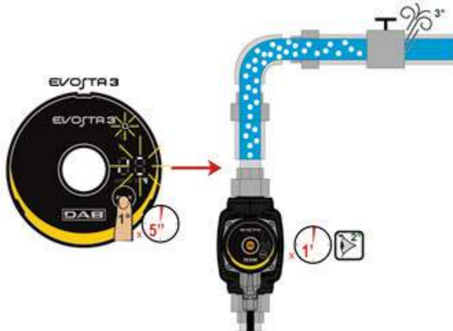
Малюнок 8: Автоматичний випуск газів з насоса
