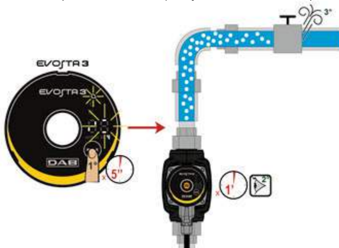
Фигура 8: Автоматично обезвъздушаване на помпата
