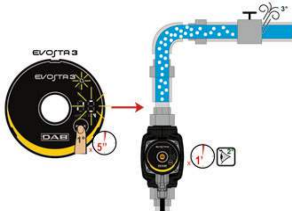
8. ábra: A pumpa automatikus légmentesítése
