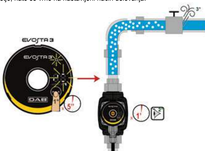
Slika 8: Avtomatska odzračitev črpalke
