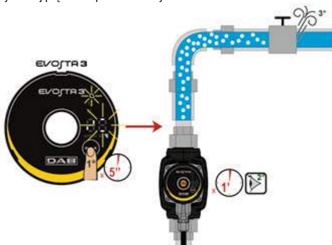
Rysunek 8: Automatyczne odgazowanie pompy
