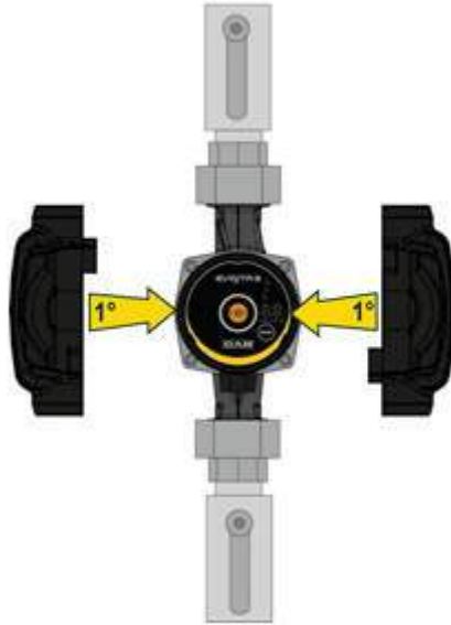
Figura 6: Isolamento do corpo da bomba
