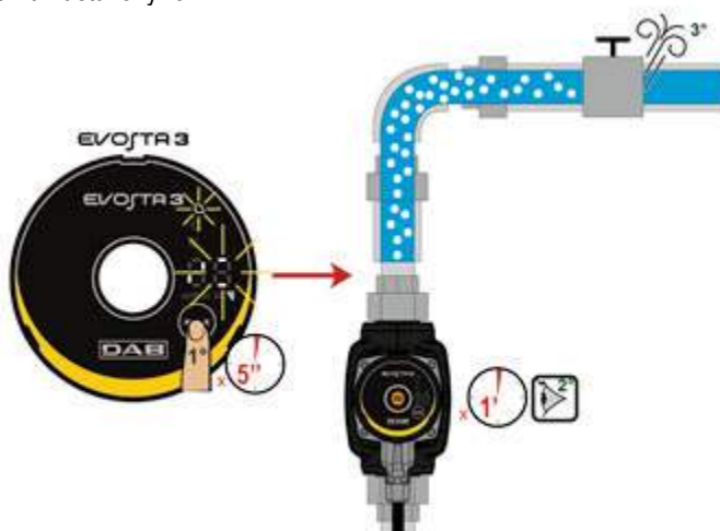
Obrázek 8: Automatické odvzdušnění čerpadla
