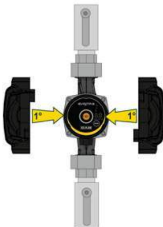
Рисунок 6: Изоляция корпуса насоса
