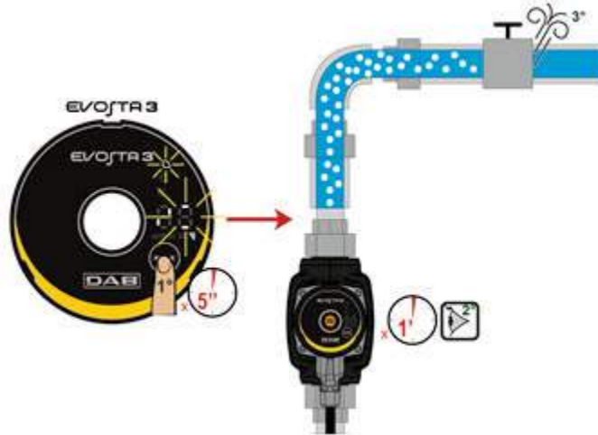
الشكل 8: التنفيس التلقائي للمضخة
