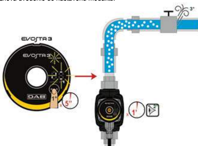
Obrázok 8: Automatické odvzdušnenie čerpadla
