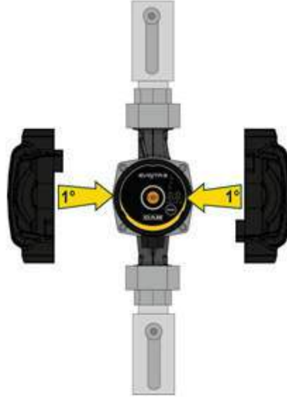
الشكل 6: عزل جسم المضخة
