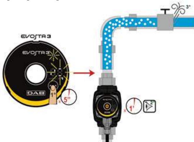
Fig. 8: Automatisk udluftning af pumpe
