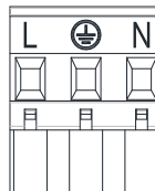
Obr. 6: Vyberateľná svorkovnica napájania
