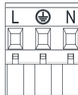
Сх. 6: Знімна клемна колодка електроживлення
