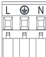
Figur 6: Udtagelig klemliste til strømforsyning
